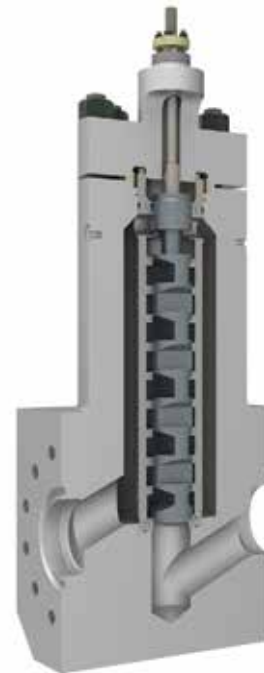
Figure 1 – Coupe transversale de la vanne 6 po
