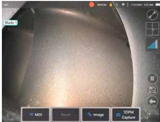
Figura 8a. Contador de Pás ativo mostrando a caixa de texto com o número da pá.
