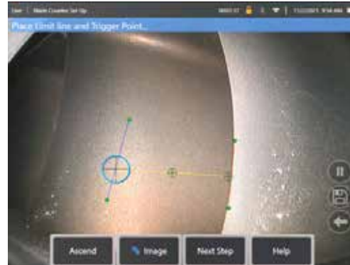
Fig. 3b. Ajuste da Linha Limite entre as Linhas de Entrada e Saída
