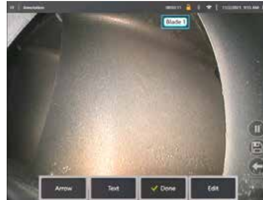
Figura 8b. Contador de Pás ativo mostrando a caixa de texto com o número da pá ajustada.
