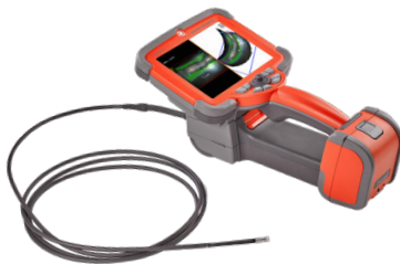
Mentor Visual iQ Touch 使用 QuickChange 探头和触摸屏提高生产效率
