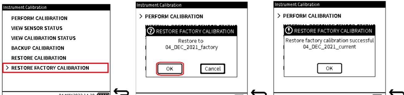
1. Selezionare **RIPRISTINA CALIBRAZIONE DI FABBRICA** dalla schermata **Calibrazione** strumento.
