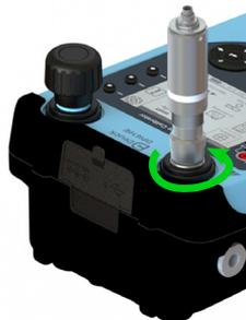
Per collegare il dispositivo in prova alla porta di prova o al trappola per lo sporco, inserire il sifone nella filettatura del connettore girevole, quindi ruotare il connettore girevole completamente in senso antiorario finché non è serrato a mano.
