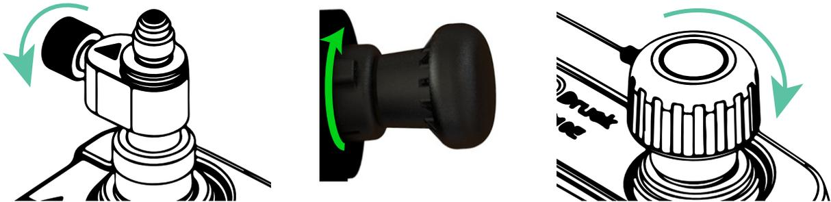
3. Assicurarsi che la valvola di discesa sia chiusa (ruotare la valvola completamente in senso orario).
