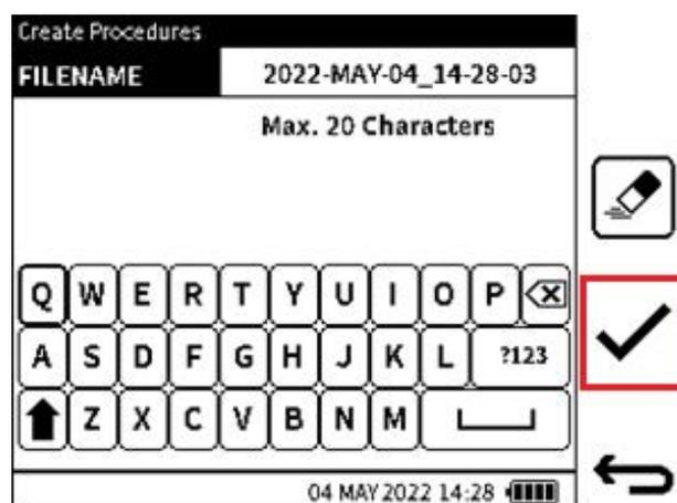
2. Immettere un nome file per la procedura di test o utilizzare il nome file predefinito. Questo nome file predefinito utilizza la data e l'ora del sistema.
