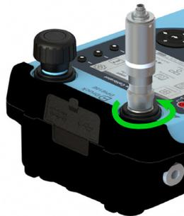
5. Per collegare il dispositivo in prova alla porta di prova o al trappola per lo sporco, tenere il dispositivo nella presa, quindi ruotare il connettore girevole alla base del connettore completamente in senso antiorario finché non è serrato a mano. Assicurarsi che il dispositivo in prova abbia una filettatura adattatore maschio G 3/8 Quickfit o utilizzare un adattatore adatto con una tensione nominale di 35 bar. In caso di dubbi, contatta il nostro Servizio e Supporto - vedi l'ultima pagina.
