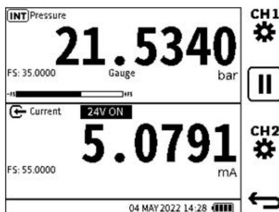
5. In questa schermata sarà selezionata solo **la funzione Corrente (Current)** con **Off (Off)**. Quando si seleziona **24 V**, **viene visualizzato Corrente (24 V)**. Selezionare l'icona Indietro ↶ per accedere alla schermata principale del calibratore. La schermata di calibrazione mostrerà **24 V ON** nell'area dello **schermo CH2**. Se è **stato selezionato Disattivato**, nella parte superiore di quest'area sarà presente solo **Corrente**.
