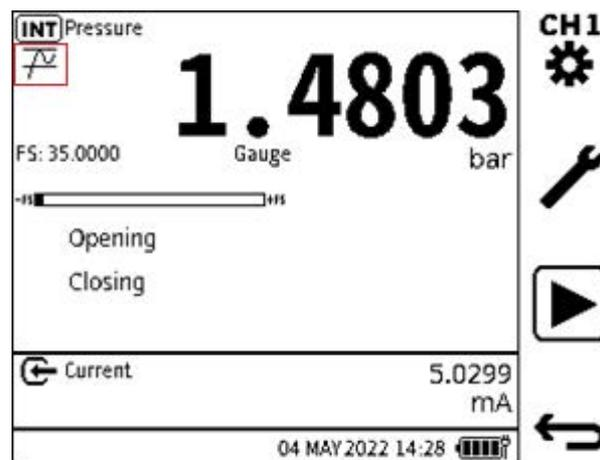
3. La schermata Calibratore verrà impostata con i dati del test della **valvola di sfiato**. La **finestra CH1** diventerà automaticamente più grande per mostrare i dati del test.
