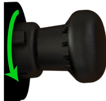
2. Assicurarsi che la valvola di scarico sia chiusa. Chiudere anche la valvola di sfiato (ruotare entrambe le valvole completamente in senso orario).
