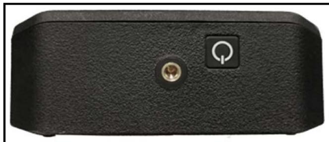
**Figura 51: Pulsante di accensione trasmettitore (alto)**
