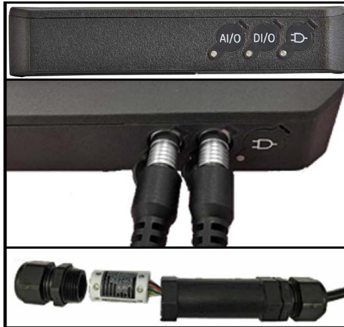
**Figura 46: Collegamenti I/O trasmettitore (lato destro)**
