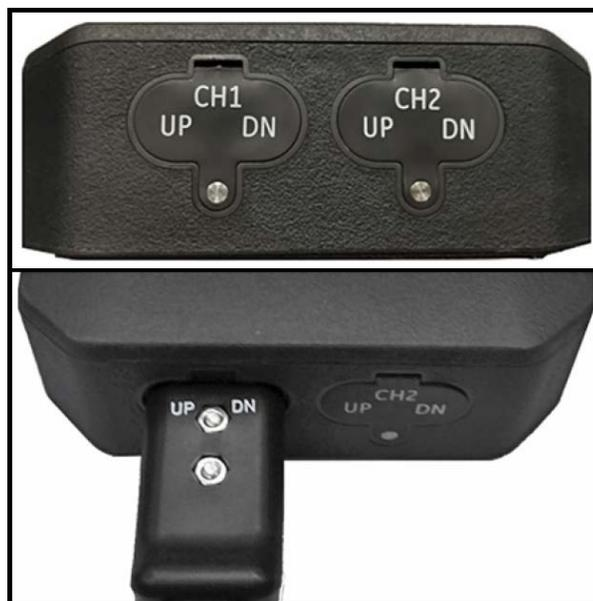
**Figura 45: Collegamenti del trasduttore (in basso)**
