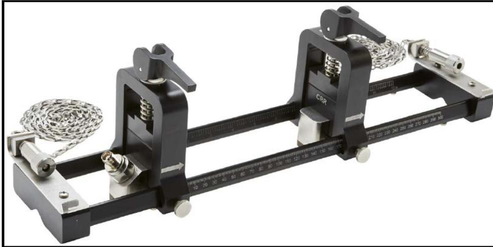
**Figura 7: Fissaggio a pinza PT9 con trasduttori CRR**
