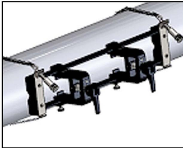
**Figura 15: Fissaggio ruotato in posizione orizzontale**
