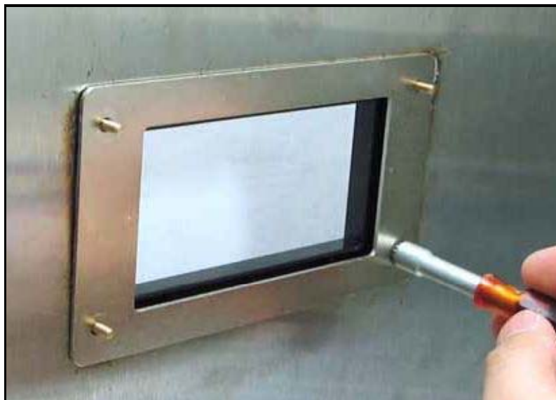
図 19：アセンブリをパネルに固定する
