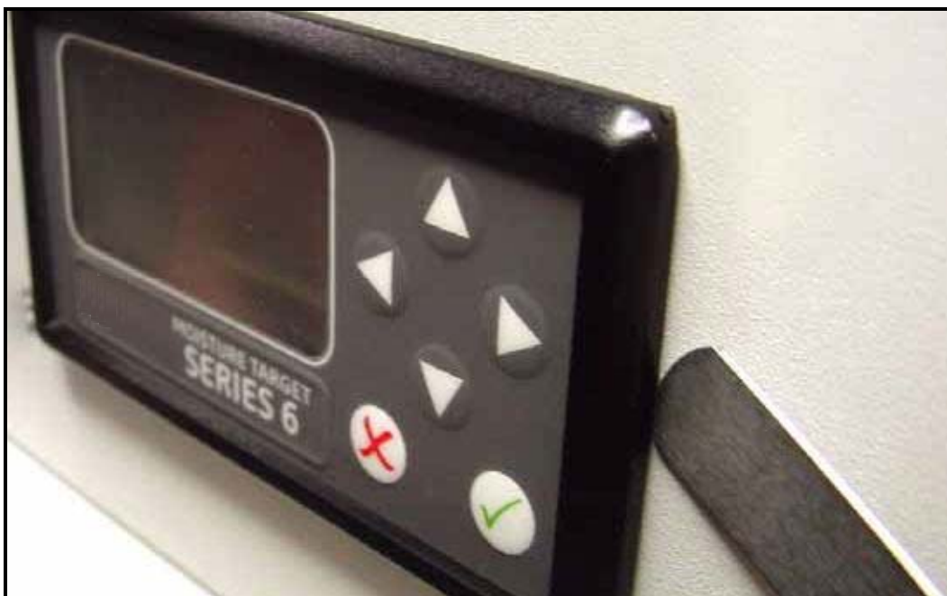
図 15：ガスケットの圧縮状態を点検する
