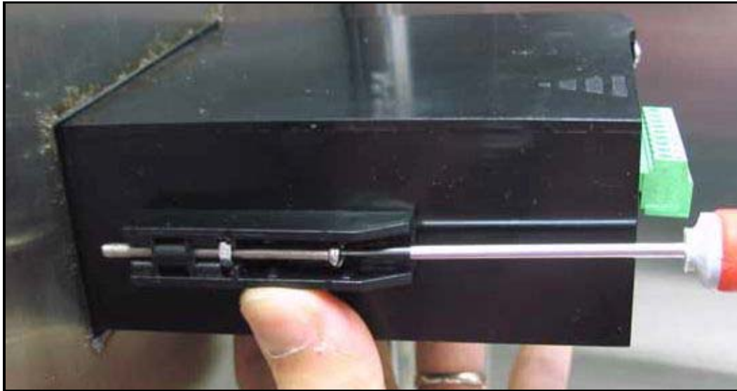
図 14：MIS6 をパネルに固定する
