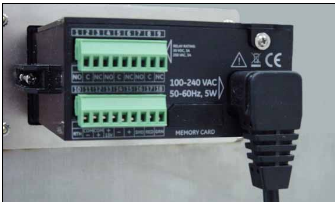
図 39 : AC 電源ケーブルを取り付けた状態
