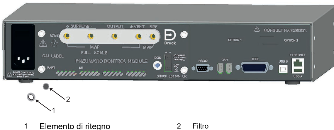
Figura 4-2: Sostituzione dei filtri del modulo di controllo della pressione
