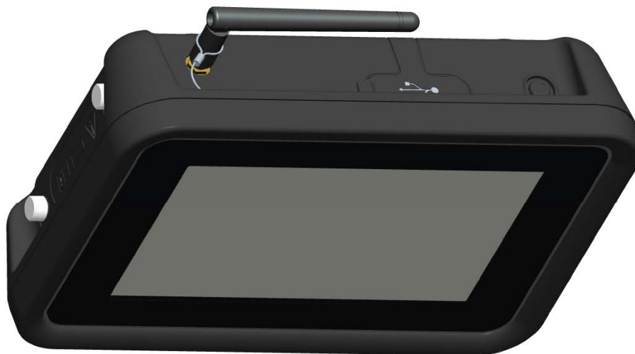
Abbildung 3-58: ADTSTOUCH-ER mit externer Bluetooth®-Antenne
