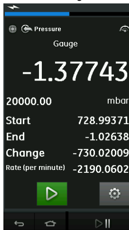
Figura 2-24: Ejemplo de Leak Test (Prueba de fugas)
