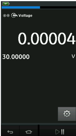
Figura 2-18: Medición de voltios CC o mV CC en CH1.
