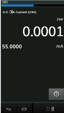
Figura 2-17: Medición de corriente en CH1. Rango: \pm 55 mA
