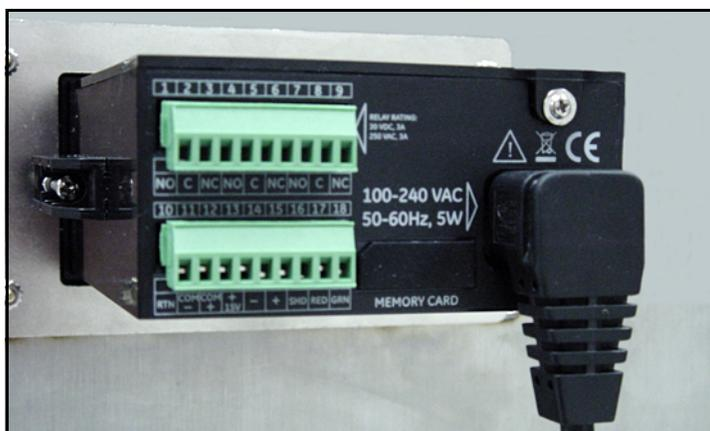
Рисунок 32: Установка кабеля питания переменного тока
