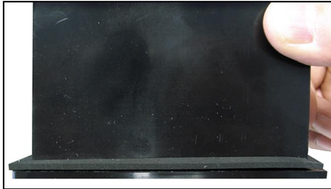
**Рисунок 10: Установка прокладки за дисплеем**
