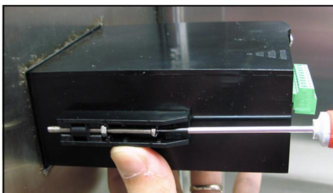
**Рисунок 14: Крепление прибора dew.IQ к панели**
