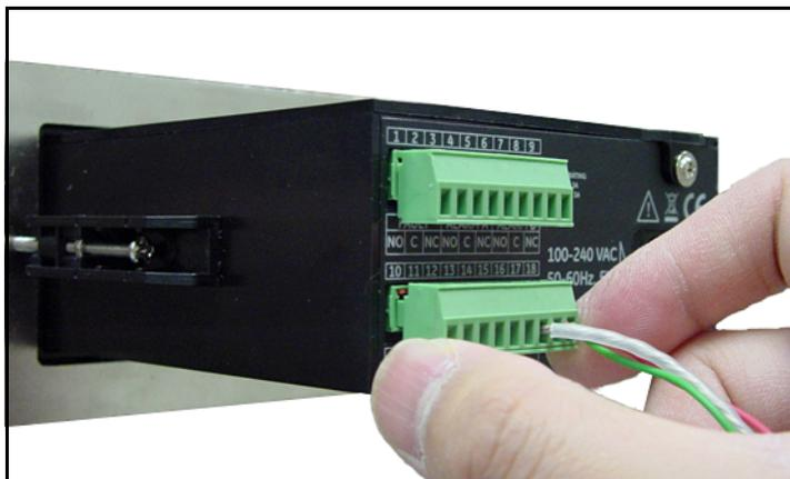
Рисунок 25: Повторная вставка соединителя в клеммную колодку
