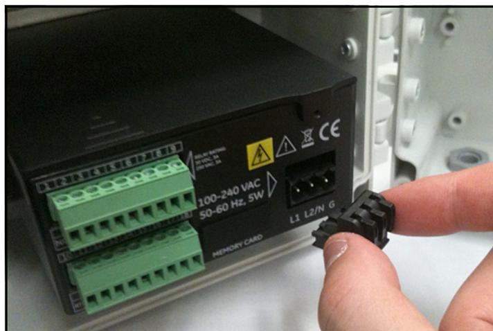
Рисунок 35: Удаление соединителя питания переменного тока
