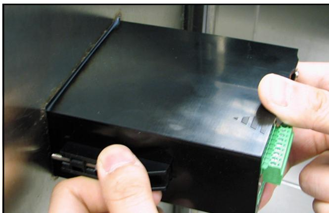
**Рисунок 13: Блокировка монтажных кронштейнов на своих местах**
