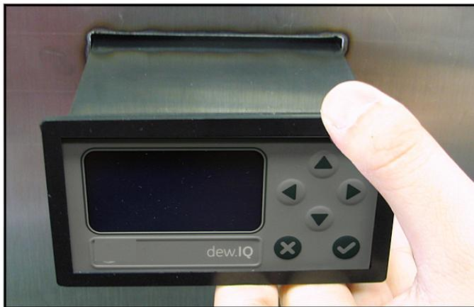
**Рисунок 11: Сдвигание прибора dew.IQ в вырез панели**
