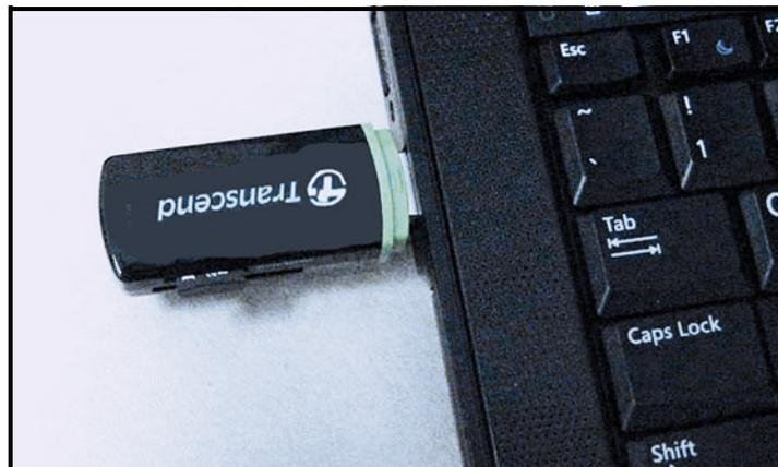
Рисунок 53: Подключение устройства для считывания с карт к ПК
