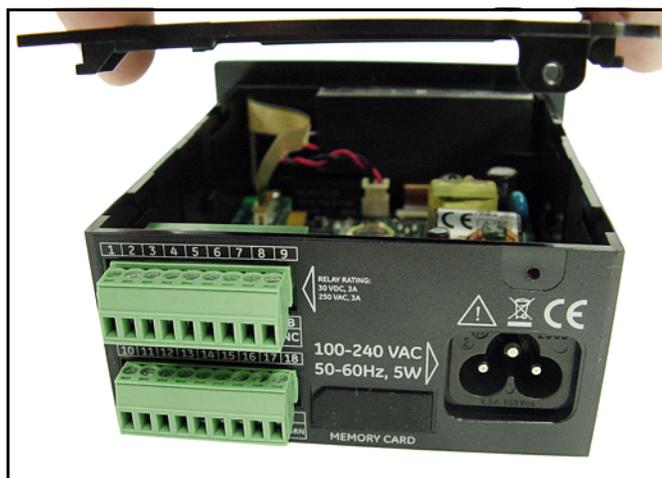
Рисунок 7: Удаление крышки
