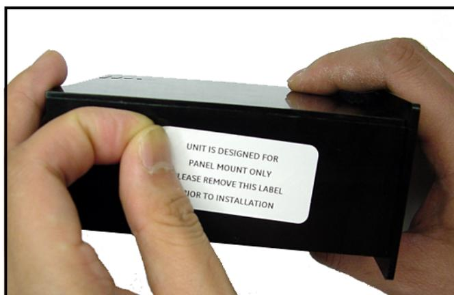
**Рисунок 9:** Удаление монтажного ярлыка боковой панели
