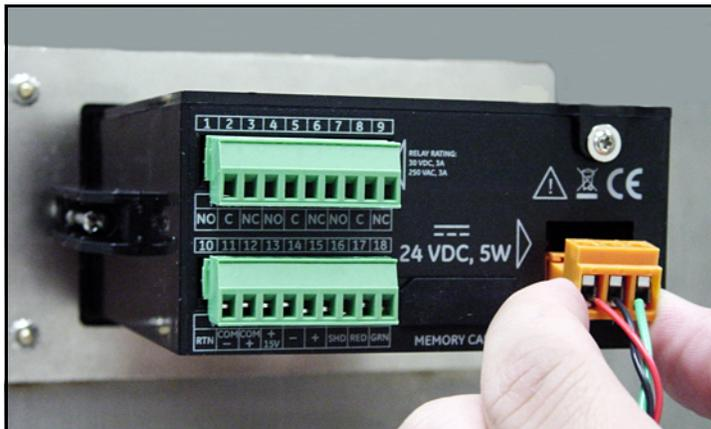
Рисунок 34: Повторная вставка соединителя питания постоянного тока
