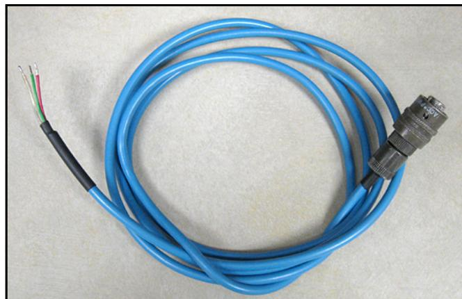
**Рисунок 21: Двухжильный экранированный кабель зонда серии M**
