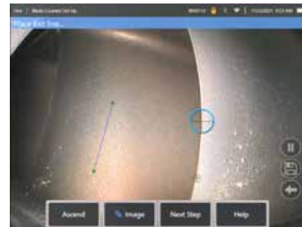
Obr. 2b. Nastavte výstupní linku na okraj aerodynamické plochy
