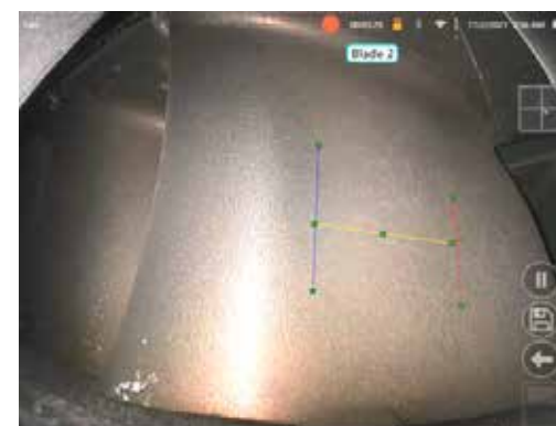
Obr. 9c. Aktivní počítadlo lopatek zobrazující původní oblast
