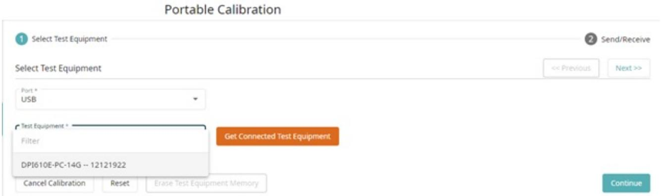
**참고 :** DPI610E 에 연결할 때 오류가 발생하면 DPI610E 가 연결되어 있고 VCP(Virtual Communications Port) 모드에 있는지 확인하십시오 . Druck Comms Server 가 설치되어 있지 않고 작동 중이 아니면 연결할 수 없습니다 .
