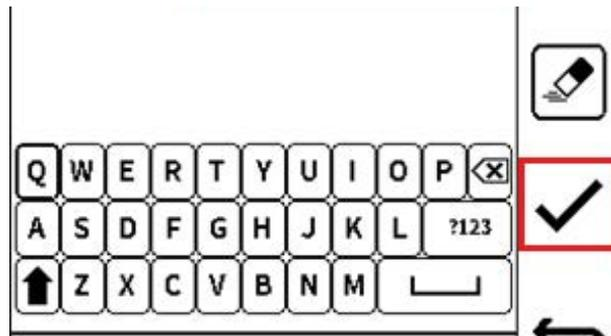
10. 기본 결과 파일 이름은 계측기의 테스트 날짜와 시간(HH:MM:SS)입니다. 필요한 경우 이름을 바꿀 수 있습니다 . Tick 소프트키를 선택하여 결과 파일 이름을 확인하고 저장 작업을 완료합니다 .
