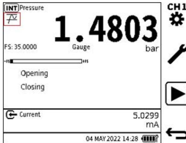
3. 캘리브레이터 화면은 릴리프 밸브 테스트 데이터로 설정됩니다. CH1 창은 테스트 데이터를 표시하기 위해 자동으로 커집니다 .
