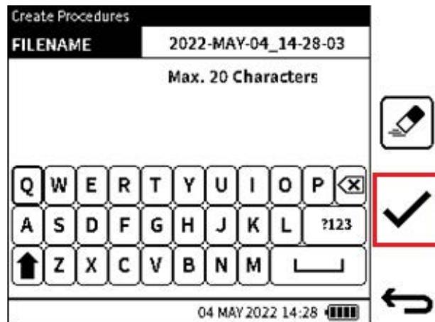
2. 테스트 절차의 파일 이름을 입력하거나 기본 파일 이름을 사용합니다 . 이 기본 파일 이름은 시스템 날짜 및 시간 스탬프를 사용합니다 .
