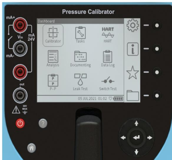
그림 1-4: 기기 사용자 인터페이스 (non-IS 및 IS) - DPI610E-A 아님
