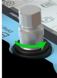
블랭킹 플러그는 테스트 포트를 밀봉합니다 . 테스트 포트를 사용하지 않을 때는 블랭킹 플러그를 부착하십시오 . 이렇게 하면 포트에 원치 않는 물질이 없습니다 .
