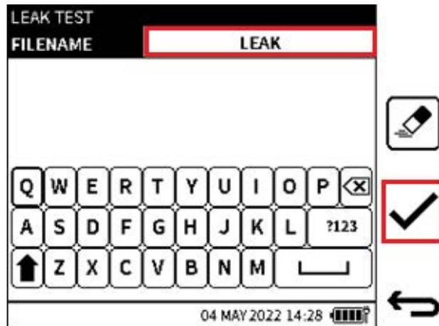
17. 테스트 결과를 저장할 수 있습니다 . 이렇게 하려면 테스트 절차가 완료되기 전에 저장
