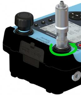
5. 테스트 중인 디바이스를 테스트 포트 또는 먼지 트랩에 부착하려면 디바이스를 소켓에 고정한 다음 커넥터 바닥의 회전 커넥터를 손으로 조일 때까지 시계 반대 방향으로 완전히 돌립니다 . 테스트 중인 기기에 수 G 3/8 Quickfit 어댑터 나사산이 있는지 확인하거나 35bar 등급의 적절한 어댑터를 사용하십시오 . 의심스러우면 서비스 및 지원에 문의하십시오 - 뒷 페이지 참조 .
