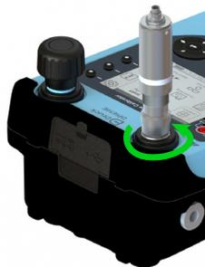
테스트 중인 디바이스를 테스트 포트 또는 먼지 트랩에 부착하려면 트랩을 스위블 커넥터의 나사산에 넣은 다음 스위블 커넥터를 손으로 조일 때까지 시계 반대 방향으로 완전히 돌립니다 .
