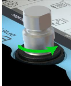
1. 블랭킹 플러그가 테스트 포트를 밀봉하는지 확인하십시오 . 블랭킹 플러그를 부착하려면 플러그를 스위블 커넥터의 나사산에 넣고 제자리를 유지한 다음 스위블 커넥터를 손으로 조일 때까지 시계 반대 방향으로 완전히 돌립니다 .
