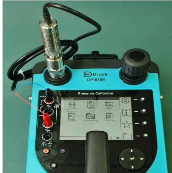
압력 커넥터 나사산이 DPI610E 테스트 포트 쿵 핏 커넥터와 동일하지 않은 경우 해당 어댑터 피팅을 사용하십시오 . 어댑터 피팅의 정격은 35barg 여야 합니다 . 의 섹션 2.1.5, ' 테스트 중인 디바이스를 연결하려면 ', 20 페이지 절차를 사용하여 ADROIT 센서를 테스트 포트에 연결합니다 .
