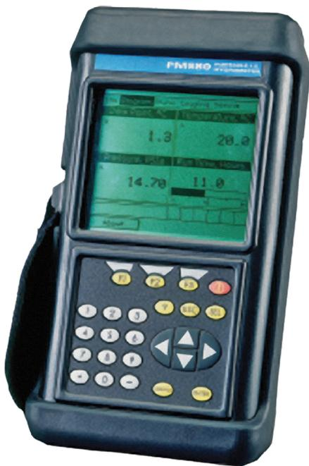
L'ampio display a cristalli liquidi (LCD) del PM880 AC visualizza le letture dell'umidità al punto di rugiada (in °C o °F), ppmv, ppmw, lb/MMSCF (gas naturale) e in un'ampia gamma di unità opzionali in formato grafico o alfanumerico.
