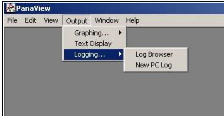
Figure 24: sous-option Log Browser (Navigateur de journaux) de l'option Logging (Enregistrement)
