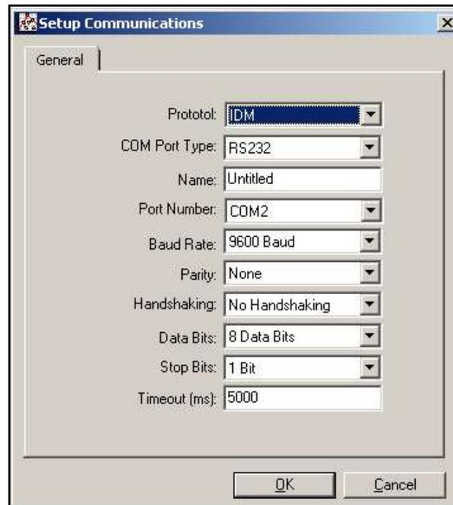
Figure 33: écran Setup Communications (Configurer les communications)
