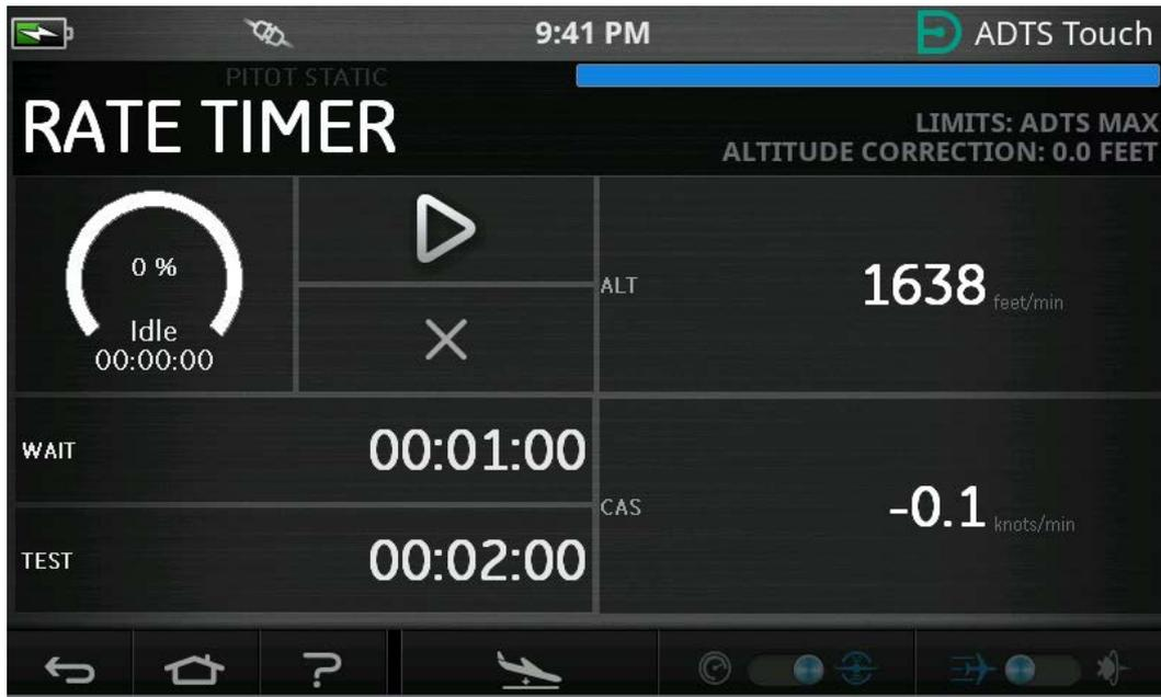
図 3-11: レートタイマーパネル - シングルチャンネル
