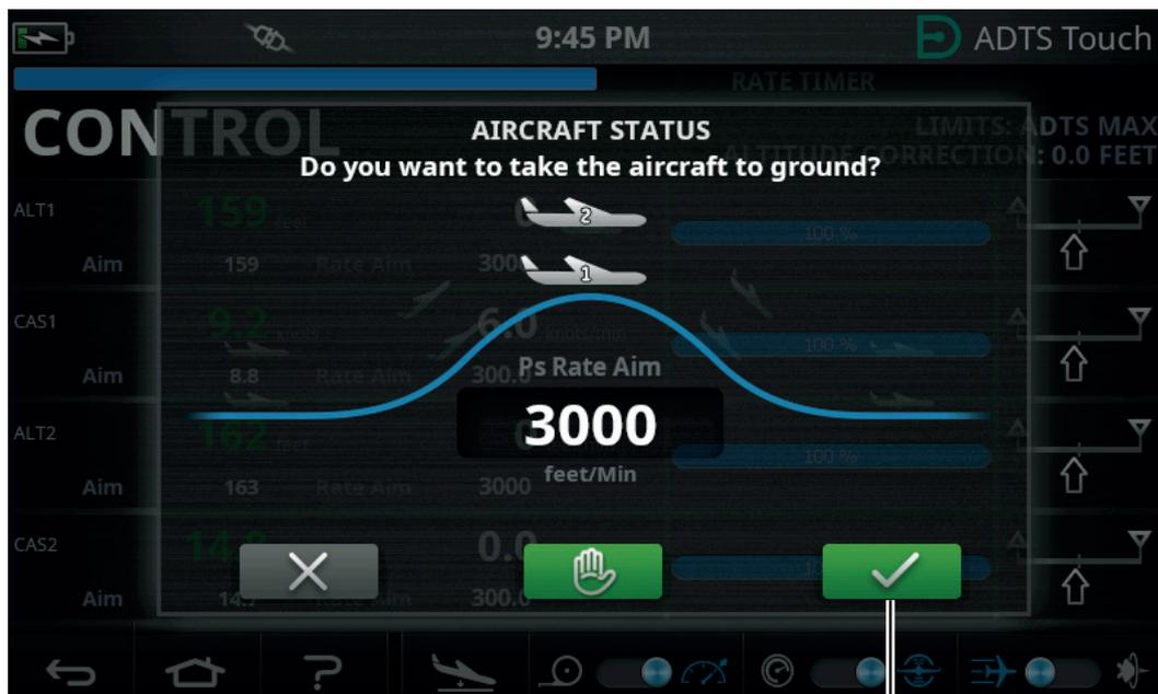
図 3-21: 「Go to Ground」アクションの開始 - マルチチャンネル
