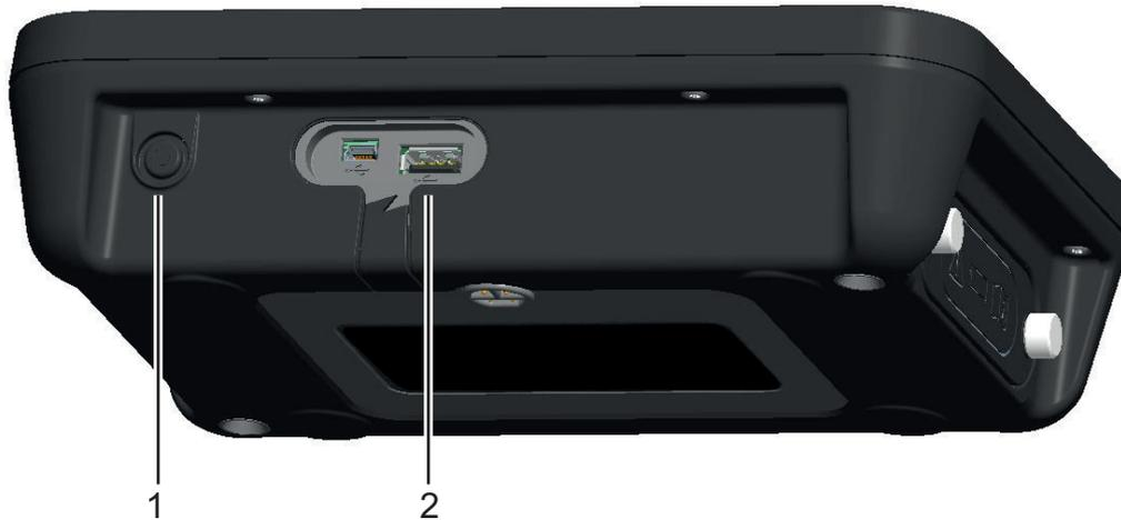
図 5-3: ADTSTOUCH の電源ボタンと USB ポート
