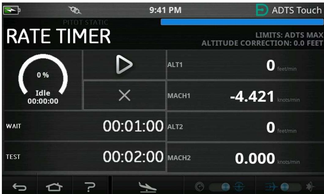
図 3-12: レートタイマーパネル - マルチチャンネル
