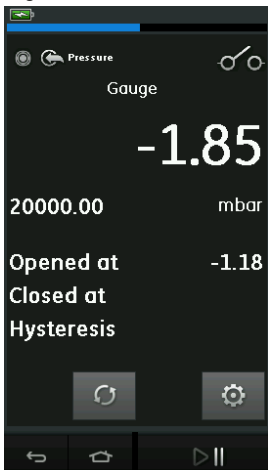
Figure 2-14 : Exemple de test de contact
