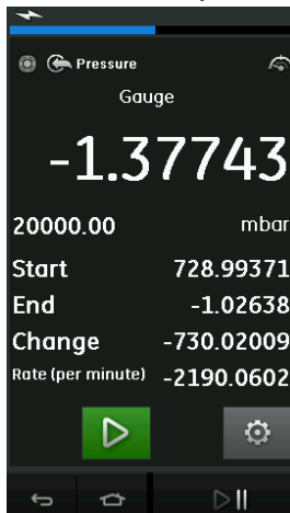
Figure 2-26 : Exemple de test d'étanchéité
