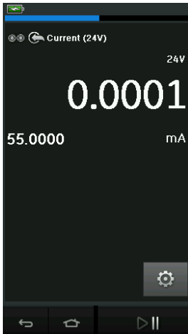
Abbildung 2-19: Strom an CH1 messen (Bereich \pm 55 mA)
