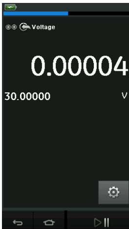
Abbildung 2-20: Gleichspannung in Volt oder Millivolt an CH1 messen.
