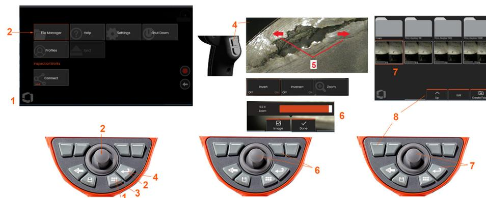
Usare il joystick per modificare la barra di ingrandimento dello zoom (anche questa e altre barre possono essere regolate trascinandole con il touchscreen), quindi selezionare Fatto. Una volta eseguito lo zoom, è possibile utilizzare il joystick per spostare la vista visualizzata.
