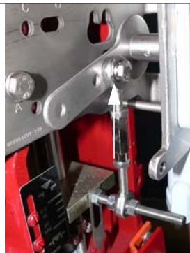
Рисунок 9. Соединение правого наконечника СТЯЖКИ
