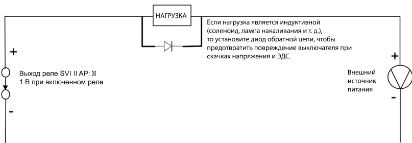
Рисунок 35 - Упрощенный монтажный чертеж переключателя: Правильная конфигурация
