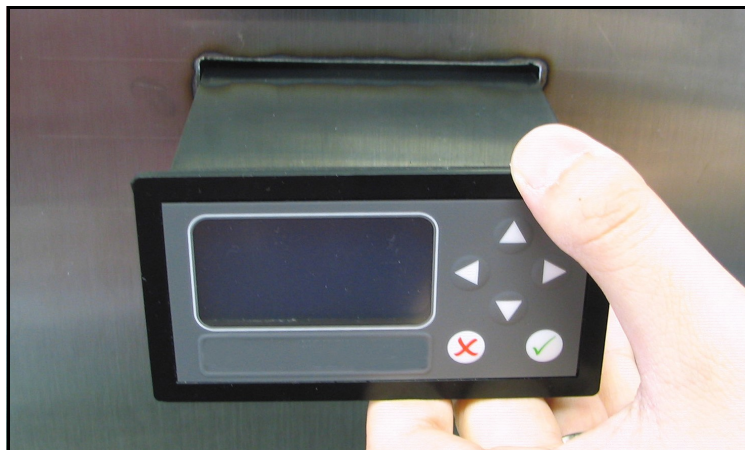
Рис. 11: Сдвиг одноканального гигрометра в вырез панели
