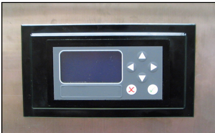
Рис. 22: Установка гигрометра с переходной пластиной - Вид спереди
