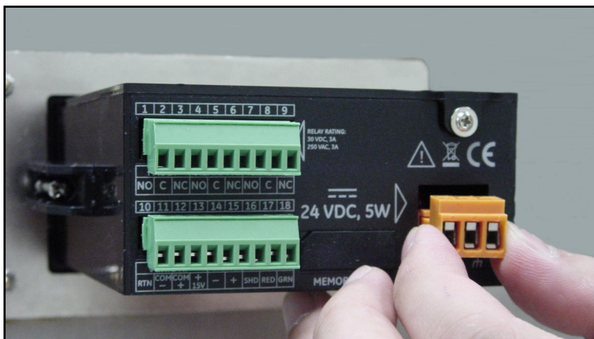
Рис. 41: Отсоединение разъема постоянного тока
