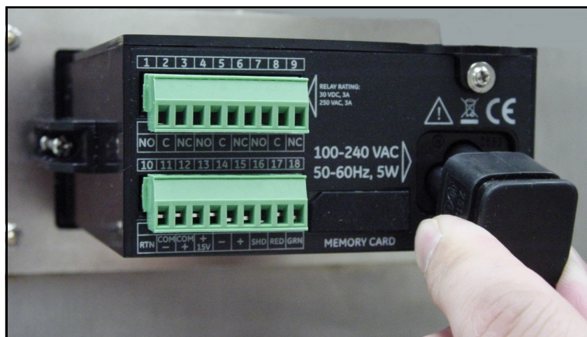
Рис. 38: Подключение кабеля питания сети переменного тока
