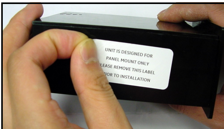
Рис. 9: Снятие этикетки с инструкциями по монтажу с боковой панели
