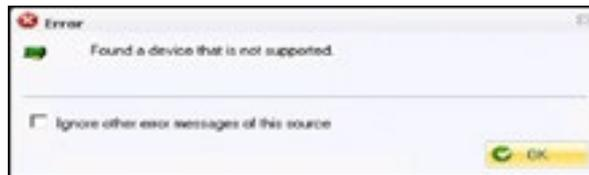
Si ValVue 3 ne parvient pas à trouver un DTM approprié pour l'appareil ajouté, le DTM affiche un message invitant l'utilisateur à utiliser la fonction « Device Type Assignments » (Affectations de type d'appareil) dans ValVue 3 afin d'assigner manuellement un DTM pour l'appareil ajouté.
