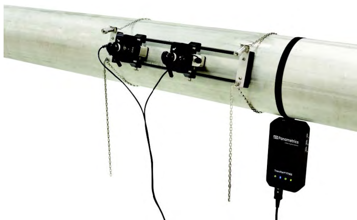
Dispositivo de fixação, transdutores e transmissor montados no tubo
