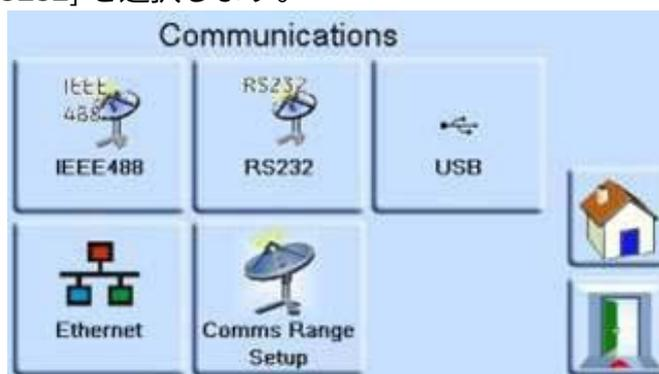
3. [RS232 パラメータ]画面で、上下の矢印を使用して設定したいパラメータを反転表示し、編集します。
