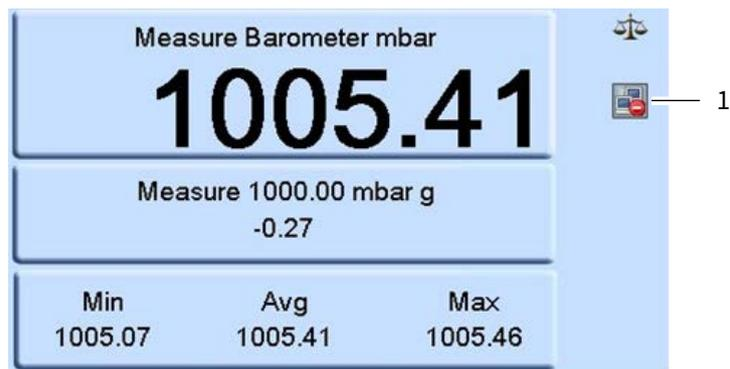
機能エリアの Min/Avg/Max は選択した測定値で実行され、トップ画面に表示されます。
