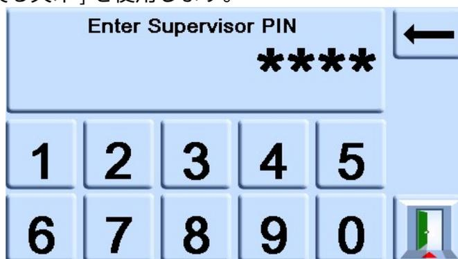
**注記:** 工場設定の管理者 PIN は 0268 です。管理者 PIN がローカルで変更されている場合は、新しい PIN が安全な場所に保管されていることを確認してください。新しい PIN を失くした場合、Druck サービスセンターでのみリセットすることができます。
