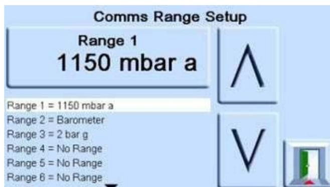
通信レンジ設定は、SCPI インデックス (x) を圧力レンジに調整するために使用されます。ここで、レンジはインデックス (1) ... などの値です。
