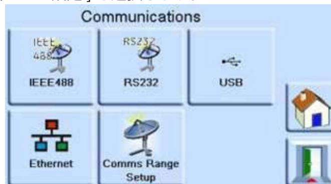
3. [通信レンジ設定]で、上下の矢印を使用して目的のレンジ(レンジ1～10)を反転表示します。
