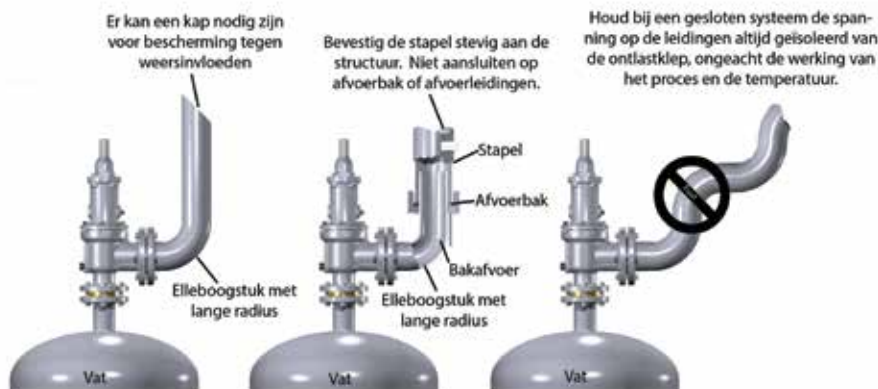
Afbeelding 14: uitlijning onderdelen overdrukklep
