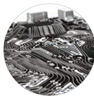
U盘线路板的三维CT扫描影像
