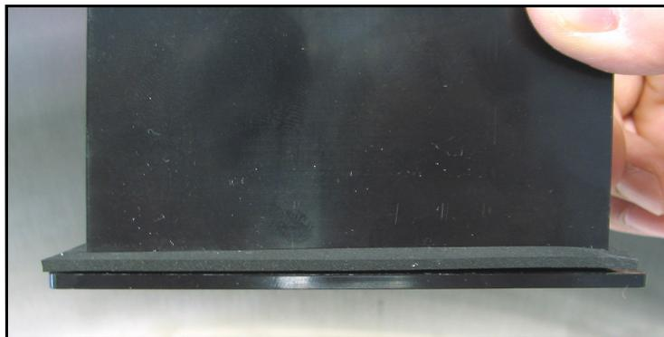
**Figura 10: Installazione della guarnizione dietro il display**
