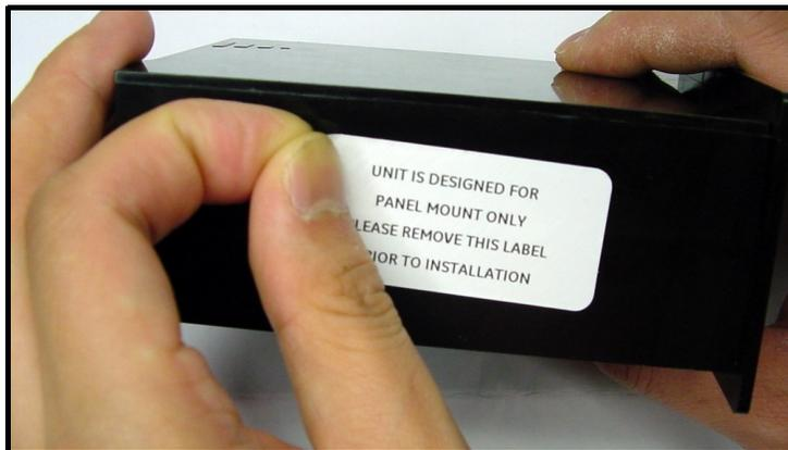
**Figura 9: Rimozione dell'etichetta laterale per il montaggio su pannello**
