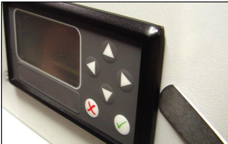
Figura 15: Verifica della compressione della guarnizione
