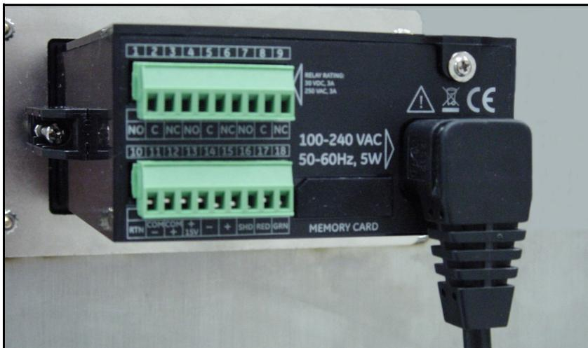
Figura 39: Cavo di alimentazione CA installato
