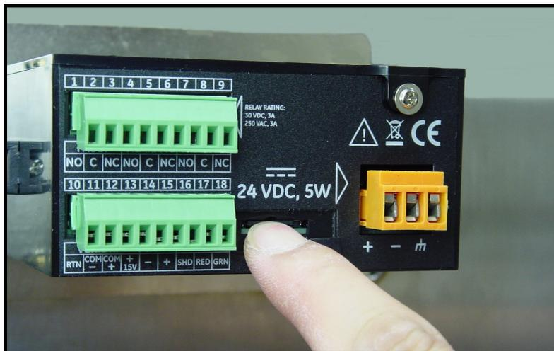
Figura 53: Inserimento della scheda micro SD
