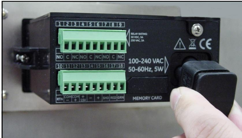
Figura 38: Inserimento del cavo di alimentazione CA
