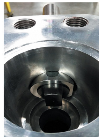
32. Ішкі сұққышқа қол жеткізу үшін сояуышты корпусстың қуысына қарай итеріңіз (17). Ішкі сұққышты ішкі көмкермеден және сояуыштан шешіп алыңыз.
