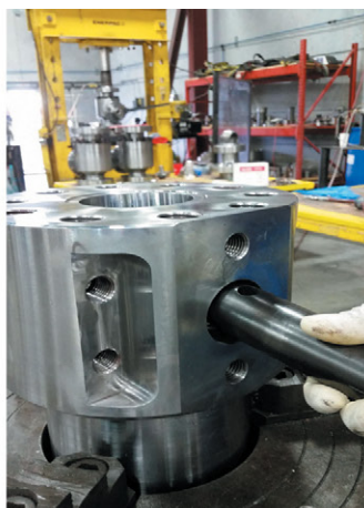
34. Сояуышты (05) саңылау арқылы корпусқа және тығыздағыш төлкеге қарай тартыңыз.
