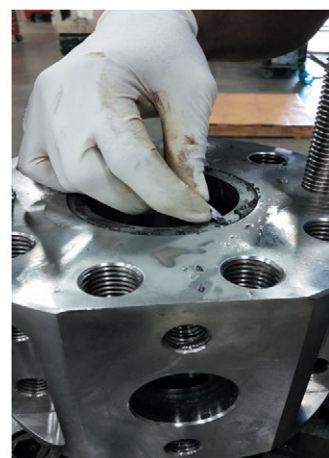
36. Клапанды ескі, пайдаланылған бөлшектердің қалдықтарынан тазарту арқылы жаңа қосалқы бөлшектерді орнатуға дайындаңыз. Жоғарыдағы фотосуретте техникалық маманның ескі тығыздағышты корпусстың бір бөлігінен қалай алып тастайтыны көрсетілген (01).
