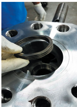
30. Шиыршықты-толқынды серіппені шешіп алыңыз (3D).
