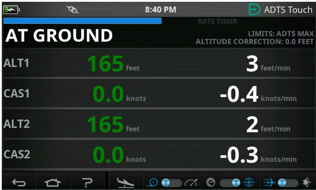
Figura 3-27: Vuelta a tierra completada – Varios canales
