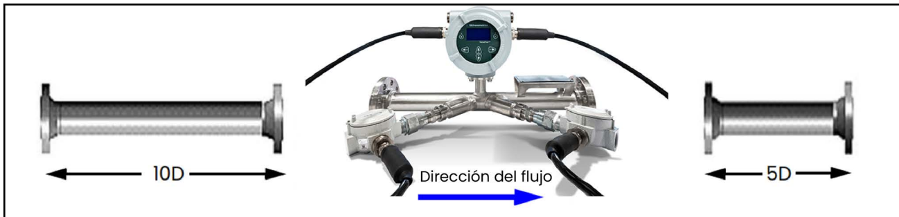
Figura 9: Requisitos mínimos para tuberías rectas
