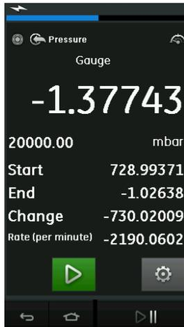
그림 2-26: 누설 테스트 예
