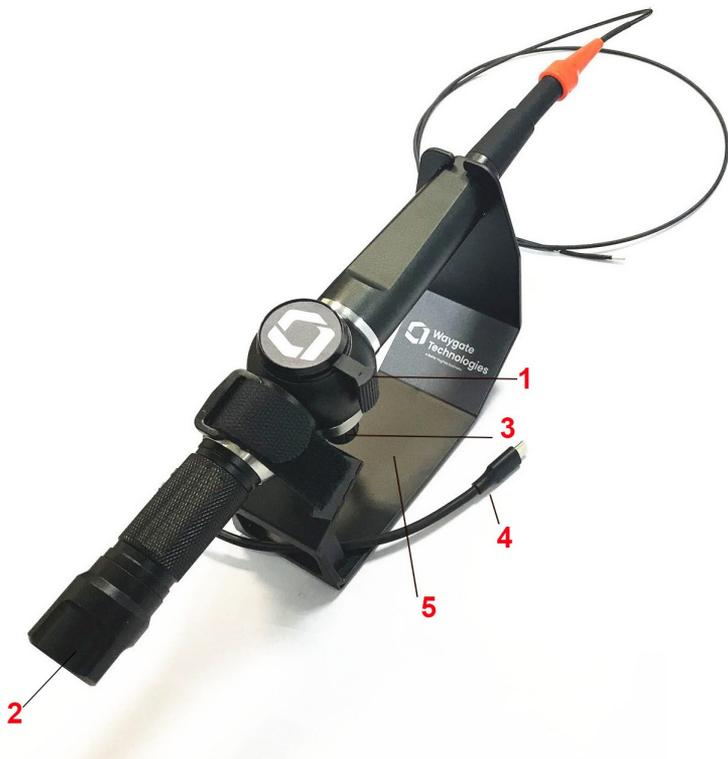
1. **Commande d'articulation** - Utilisée pour la commande d'articulation à deux voies.
