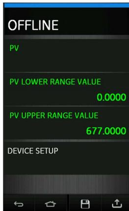
Abbildung 9-11: HART® Offline – Gerätekonfiguration
