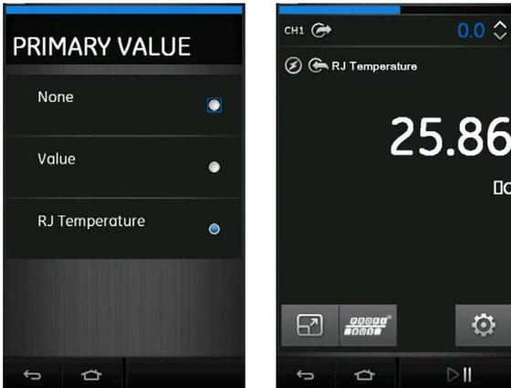
Abbildung 11-26: Anzeigen eines Primärwerts
