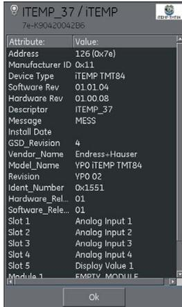
**Abbildung 11-10: Profibus®-Geräteprofil**
