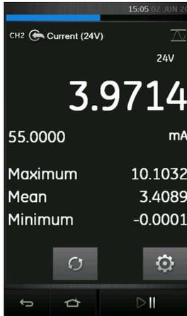
**Abbildung 3-13: Beispiel für „Max/Min/Avg“ (Maximum/Minimum/Mittelwert)**
