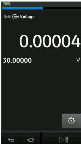
Abbildung 2-18: Gleichspannung in Volt oder Millivolt an CH1 messen.
