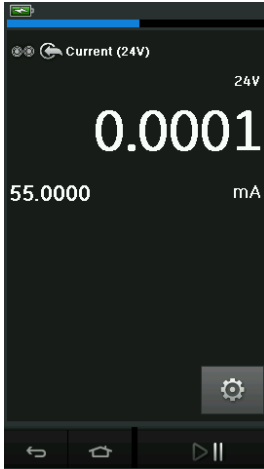
Abbildung 2-17: Strom an CH1 messen. Bereich \pm 55 mA
