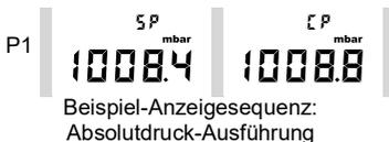
Auf den Sollwert (SP) folgt der gemessene Druck – CP. Diese Sequenz wird fortgesetzt, bis der Wert für Punkt 1 bestätigt oder abgelehnt wird.
