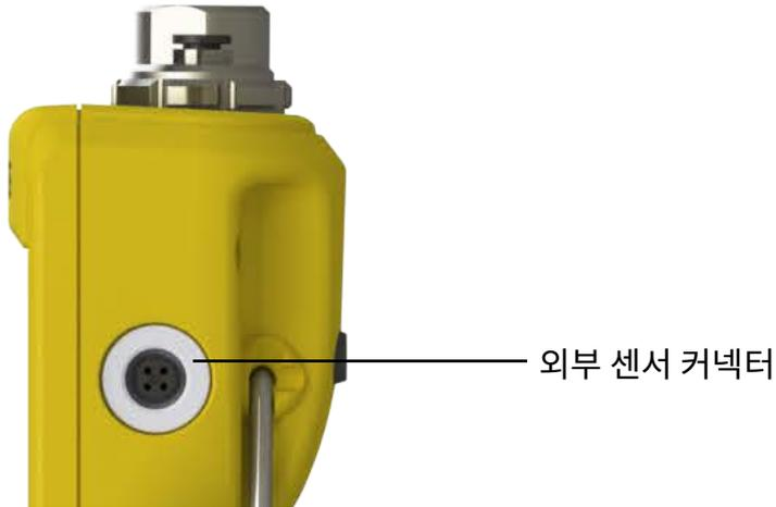
센서는 지원되는 연결 케이블을 통해 연결해야 합니다 ( 직접 연결하지 않으면 올바르게 체결되지 않습니다 ). 커넥터를 밀어 넣으면 ( pip 기능을 정렬하면 ) 외부 본체가 시계 방향으로 돌아가 커넥터를 제 위치에 고정합니다 . 여러 개의 케이블을 직렬로 ( 연장선과 같이 ) 연결할 수 있습니다 . 긴 케이블 연결이 필요한 경우 최대 10 개까지 직렬연결이 가능합니다 .
