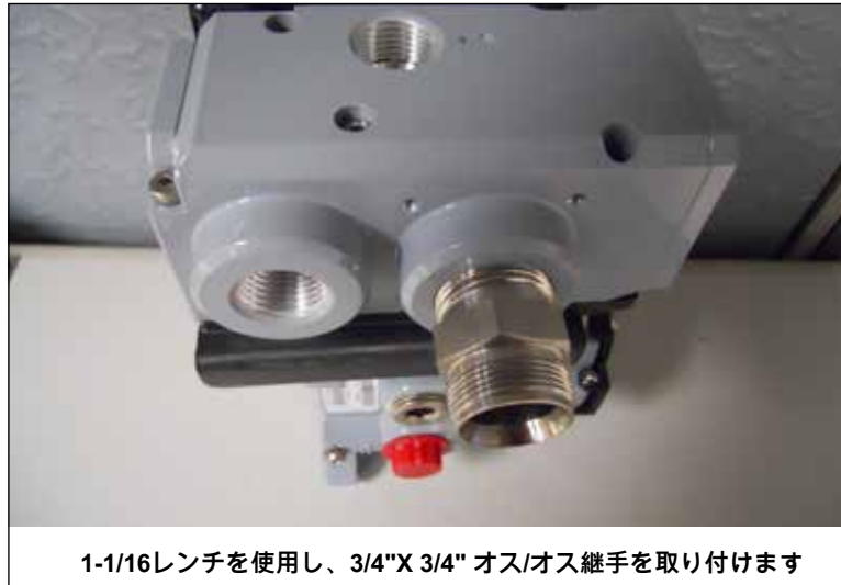
図68 - ステップ1 3/4" x 3/4"継手の取り付け
