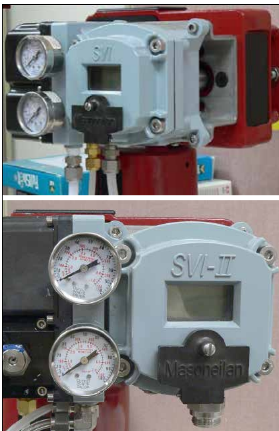
図67 - ステップ4 ガス供給と排気の接続
