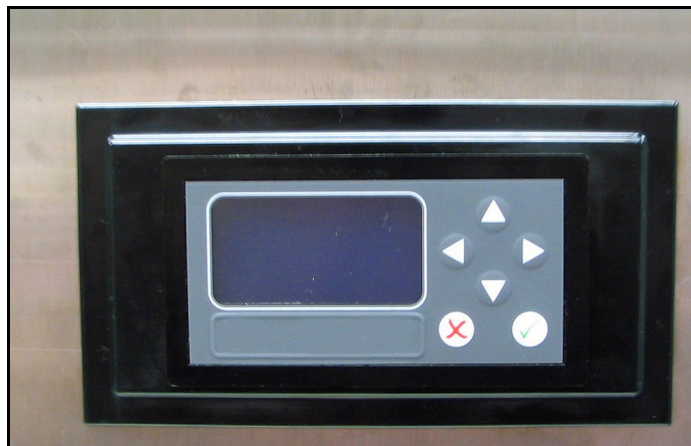
Figuur 22: Installatie hygrometer met adapterplaat - voorkant
