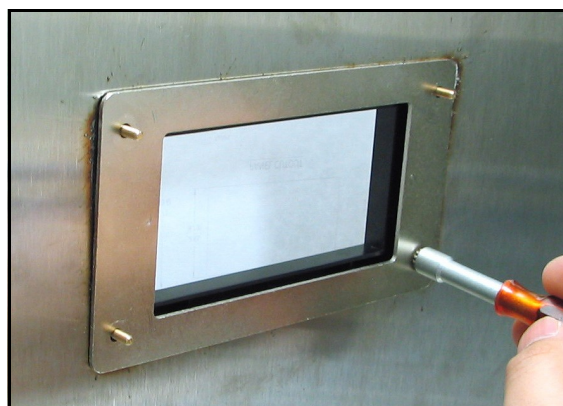
Figuur 19: De plaat aan het paneel bevestigen
