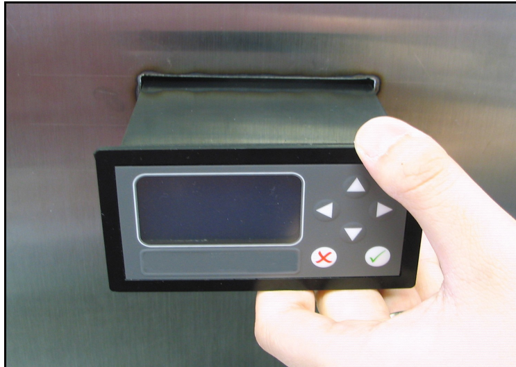
Figuur 11: De hygrometer in de paneelopening schuiven
