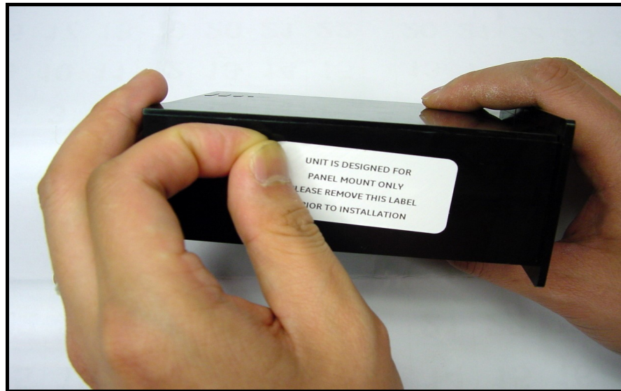
Figuur 9: Het montagelabel van het zijpaneel verwijderen
