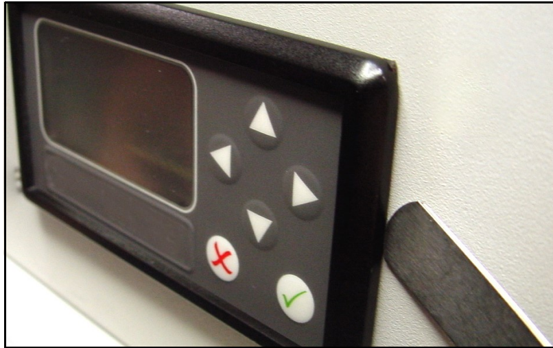
Figuur 15: De pakkingcompressie controleren
