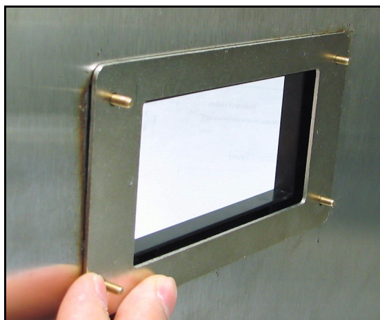
Figuur 18: De achterplaat aanbrengen
