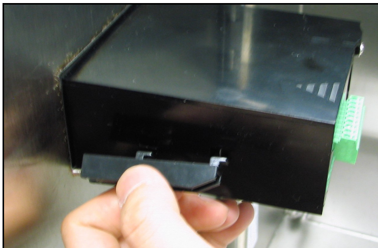
Figuur 12: De montagebeugels installeren
