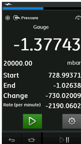
Figura 2-26: Exemplo de teste de vazamento
