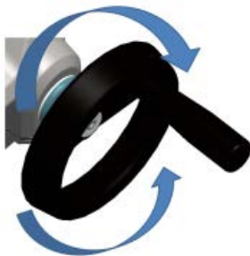
Figura 1-10: Ajuste de volume do DPI612 pFlexPro
