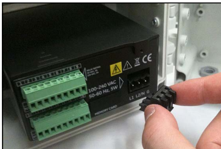
図 35 : AC 電源コネクタを取り外す
