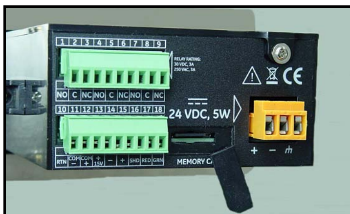
図 49：メモリーカードホルダーが露出した様子
