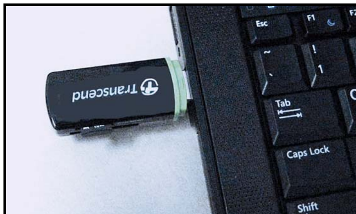
図 53 : カードリーダーを PC へ差し込む
