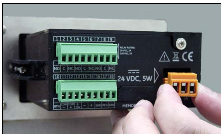
図 33 : DC 電源コネクタを外す
