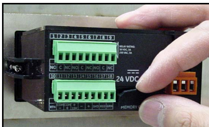
図 48：フレキシブルカバーを引っ張る
