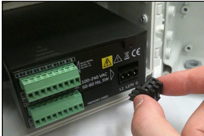
Figure 36: Retrait du connecteur d'alimentation CA
