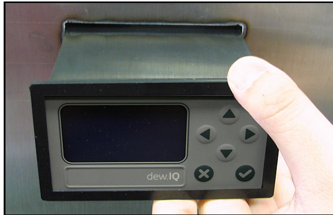
Figure 11: Insertion du dew.IQ dans la découpe du panneau
