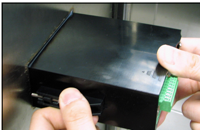
Figure 13: Blocage des supports de fixation en place
