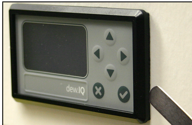
Figure 15: Vérification de la compression du joint
