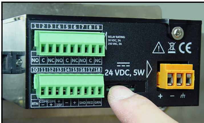
Figure 51: Enfoncement de la carte MicroSD
