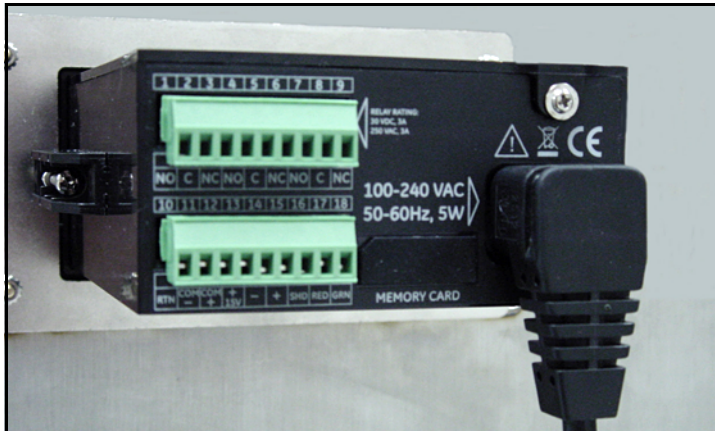
Figure 33: Câble d'alimentation CA branché
