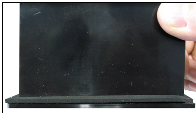
Figure 10: Pose du joint sur la face arrière de l'afficheur
