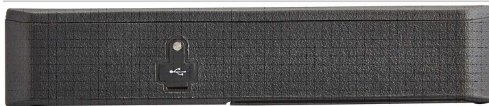
Afbeelding 48: USB-connector van transmitter (linkerkant)
