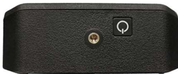
Afbeelding 51: Aan/uit-knop transmitter (boven)
