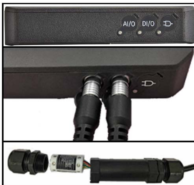
Afbeelding 46: I/O-aansluitingen transmitter (rechterkant)
