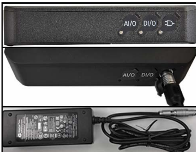
Afbeelding 44: Voedingsaansluiting transmitter (rechterkant)
