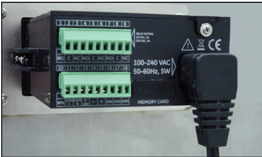
Figura 39: Cable de alimentación de CA instalado
