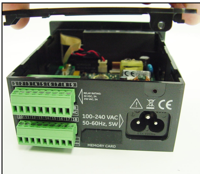
Figura 7: Levantamiento de la cubierta
