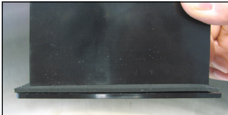
Figura 10: Instalación de la junta detrás de la pantalla
