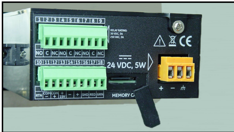
Figura 52: Alojamiento de la tarjeta de memoria abierto
