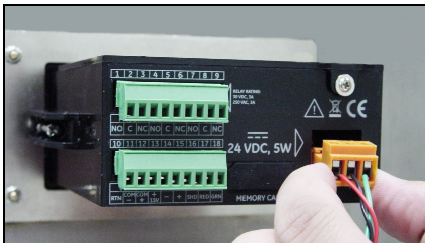
Figura 42: Reinscripción del conector de CC
