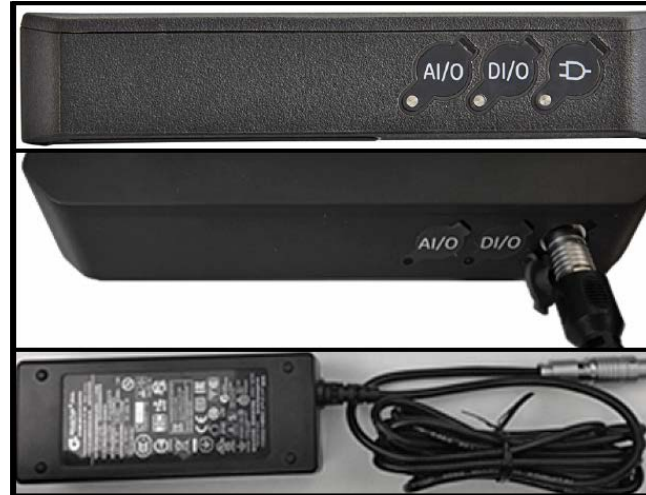
Figure 44: branchement d'alimentation du transmetteur (côté droit)
