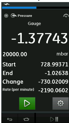
Рисунок 2-26: Пример проверки на утечки
