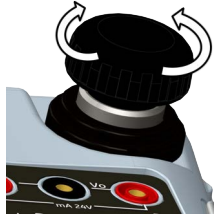
Рисунок 1-5: Перепускной клапан давления
