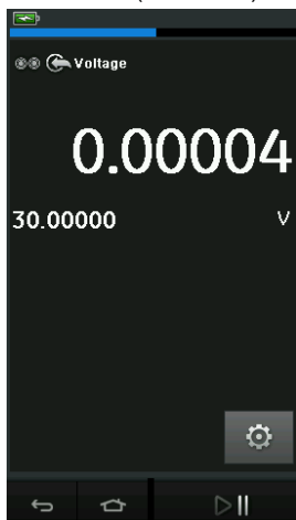
Рисунок 2-20: Измерение напряжения постоянного тока в В или мВ в канале CH1
