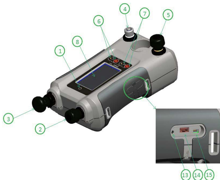
Рисунок 1-3: Устройство калибровки давления DPI612
