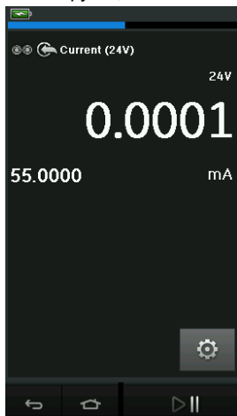
Рисунок 2-19: Измерение тока на канале CH1. Диапазон \pm 55 mA
