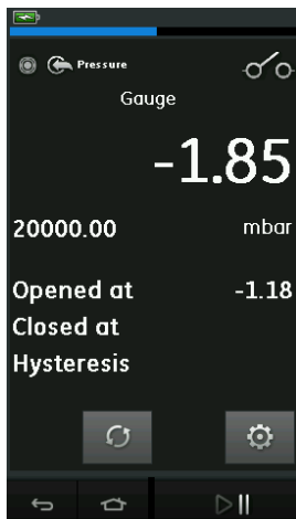
Рисунок 2-14: Пример тестирования переключателя
