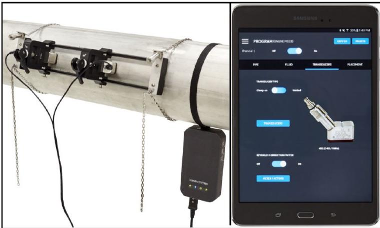
그림 1: 배관에 장착된 PT900 시스템
