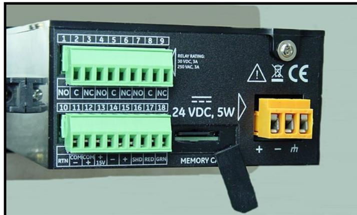
Figura 49: Soporte expuesto de la tarjeta de memoria
