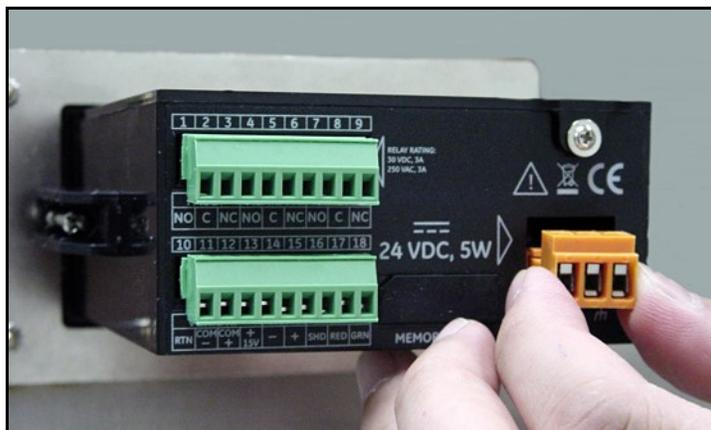
Figura 33: Extracción del conector de alimentación de CC
