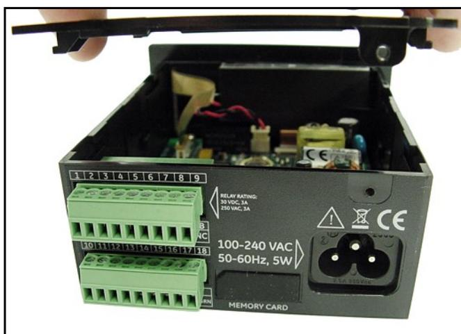
**Figura 7: Extracción de la cubierta**
