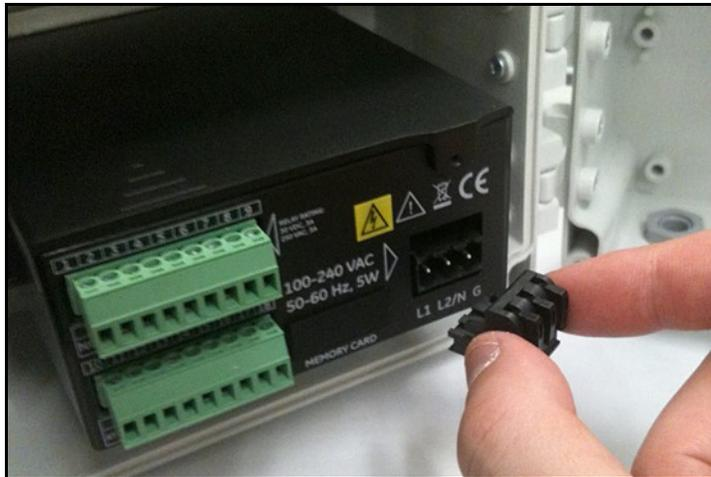
**Figura 35: Extracción del conector de alimentación de CA**
