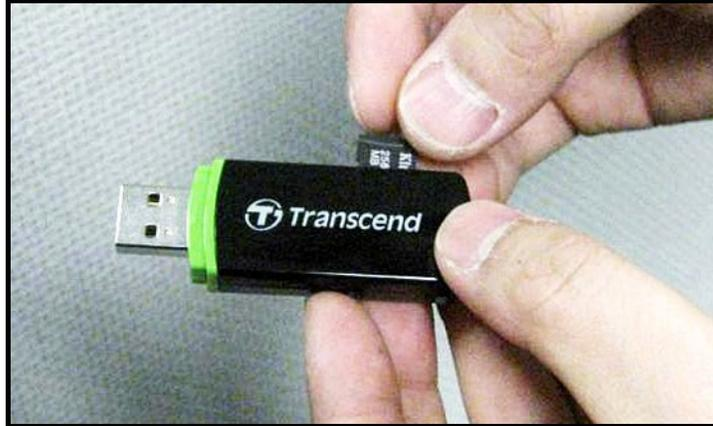
Figura 52: Enchufar la tarjeta MicroSD en un lector de tarjetas
