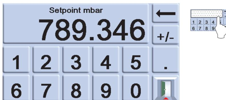
3. Löschen Sie bei Bedarf mit der Taste ← die letzte Ziffer im Anzeigefeld für den Sollwert.
