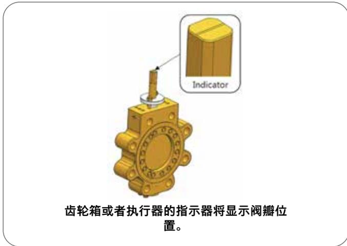
图 1 : 齿轮箱或者执行器的指示器
