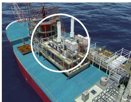
高压注气压缩机
